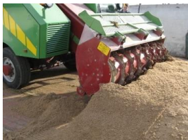
Fräse / Strukturwalze Schneidschild (beweglich)
